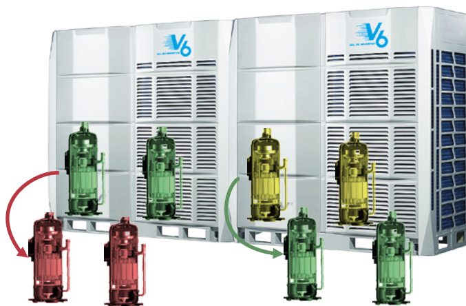
Аварийное резервирование компрессоров в модуле наружных блоков
