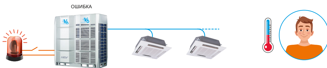
Сухой контакт размыкается при возникновении ошибки. Есть время исправить неисправность.
