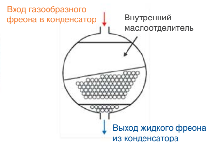
Встроенный маслоотделитель конденсатора
