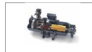
Двухвинтовой высокоэффективный компрессор Hanbell . Запатентованная конструкция подшипника с высокой устойчивостью к нагрузке обеспечивает непрерывную работу чиллера ≥ 50000 часов. Новый модуль защиты обеспечивает защиту от перефазировки или в случае пропадания фазы, а также в режиме реального времени контролирует температуры обмоток двигателя и нагнетания
